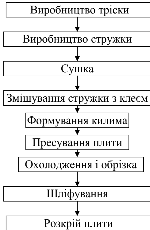
Рис. 3.3.2 Блок-схема технологічного процесу
