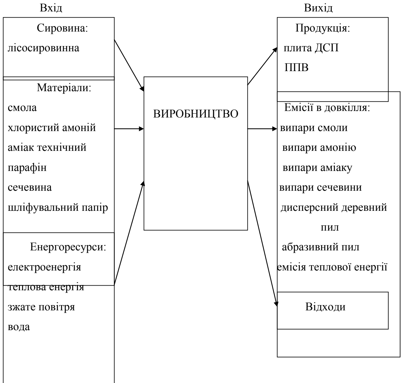
Рис.3.3.1. - Схема екобалансу виробництва плити ДСП
