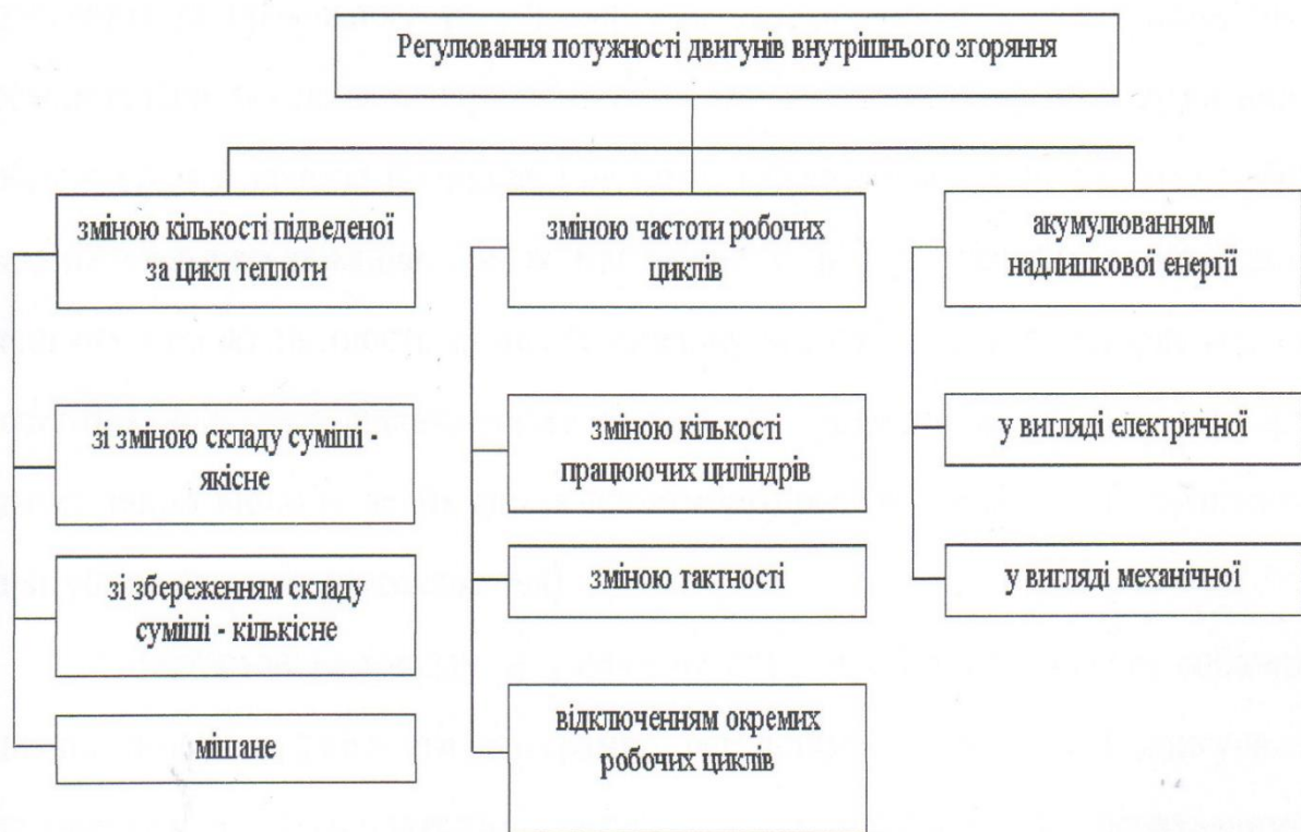
Рисунку 3.7 – Основні способи регулювання потужності ДВЗ
