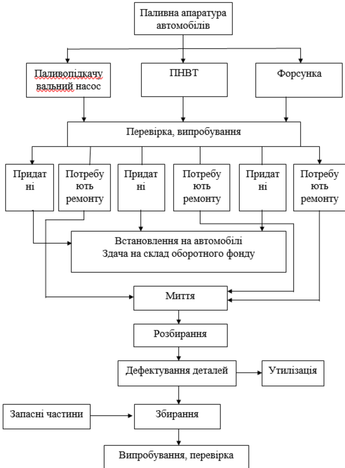
Рисунок 1.3 - Схема технологічного процесу робіт у паливній дільниці
