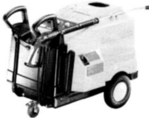
Рисунок 1.8 – Пересувні установки для миття автомобілів мийними пістолетами
