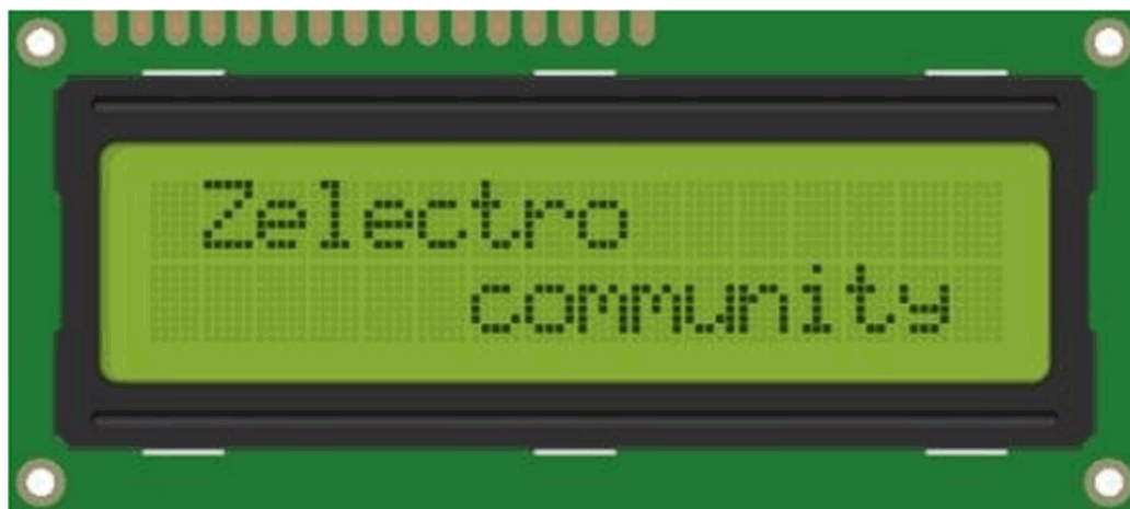
Рисунок 2.7 – LCD-дисплей із розширенням 16x2
