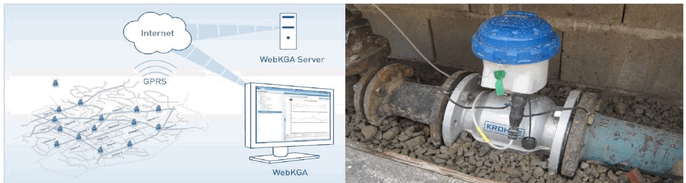
Рисунок 1.1 – Система WATERFLUX 3070 С для віддаленого моніторингу споживання води
