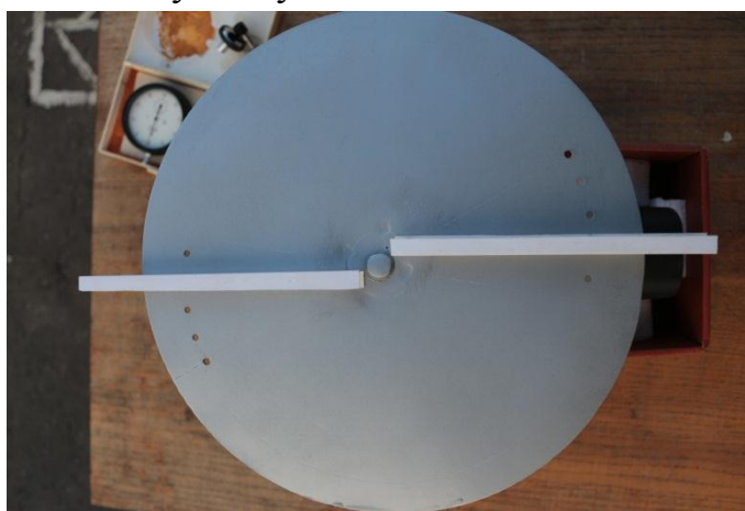
Рис. Пристрій для дослідження дальності польоту частинки мінеральних добрив.
