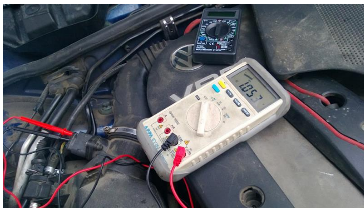
Рисунок 1.5 – Вихідна напруга ДВП на увімкненому запаленні чи на холостому ходу двигуна [14].
