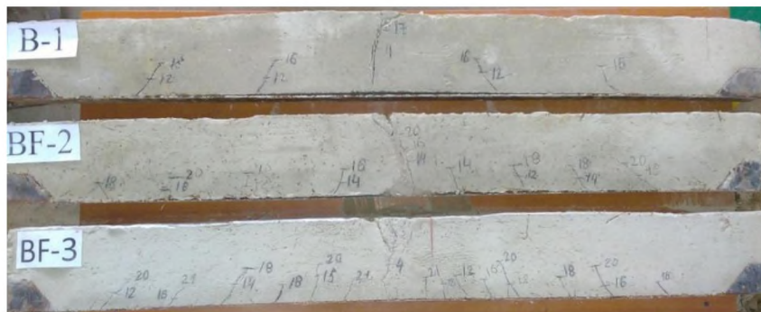
Рис. 4. Характер тріщиноутворення у дослідних балках.
