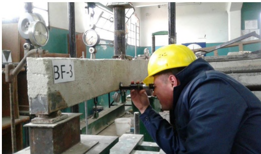
Рис. 3. Сталефібробетонна балка під час випробувань.
