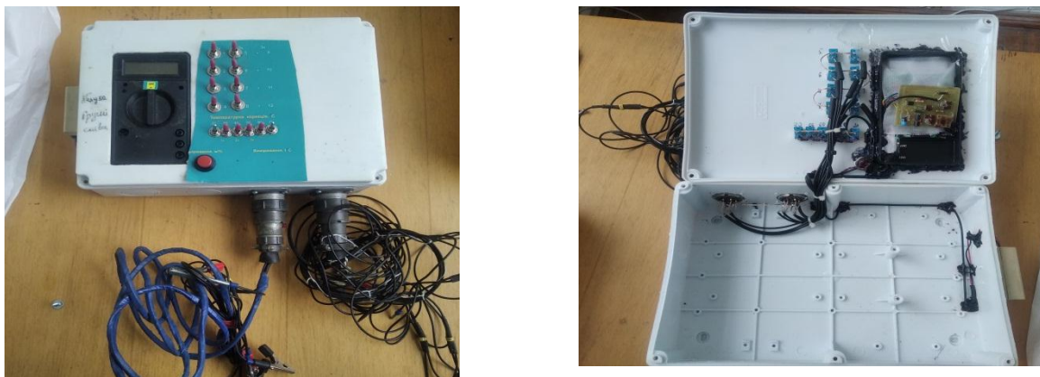
Рисунок 3.18 – Загальний вигляд чотириканального блоку управління вологоміра
