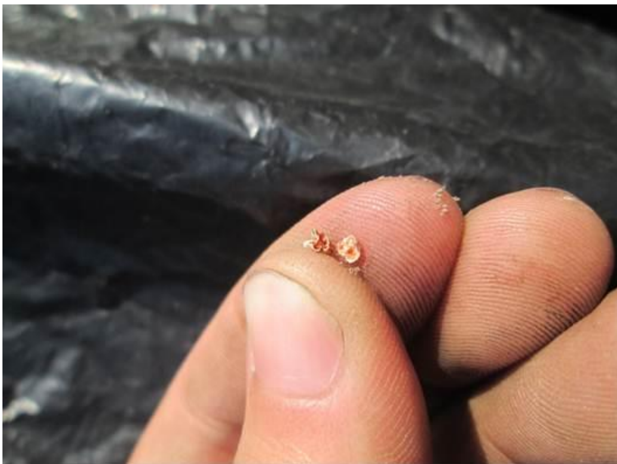
Рис. 3.7. Залишки оболонок капсули КД №2 після 90-ти денного вегетаційного періоду (2013 р.) .
