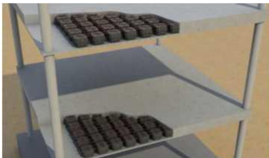
Рис. 6.11 Незнімна опалубка для перекриття New Nautilus
