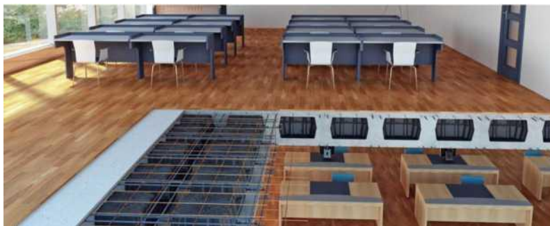
Рис. 6.12 Розміщення пустотоутворювачів у плитах перекриття
