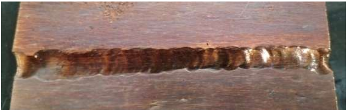
Рисунок 4.9 – Напускове зварне з'єднання Н1 листової міді М1 товщиною 3 мм
