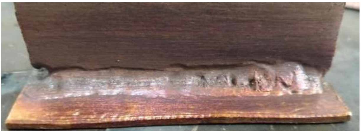
Рисунок 4.8 – Таврове зварне з'єднання Т1 листової міді М1 товщиною 3 мм
