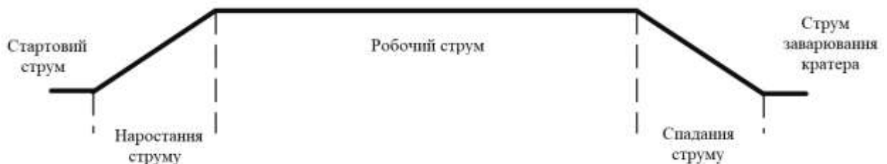
Рисунок 3.4 – Схема керування зварювальним струмом
