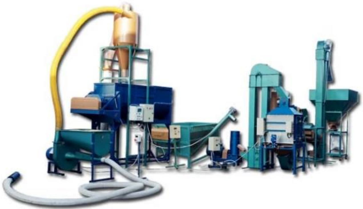
Рисунок 1.2 — Автоматизована лінія гранулювання кормів
