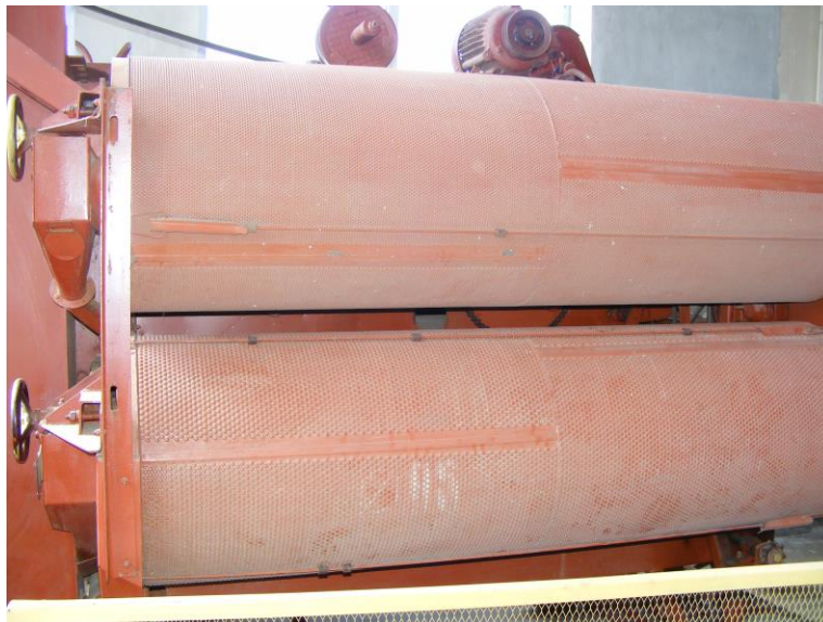
Рисунок 1.7 - Трієрні барабани машини СМ-4
