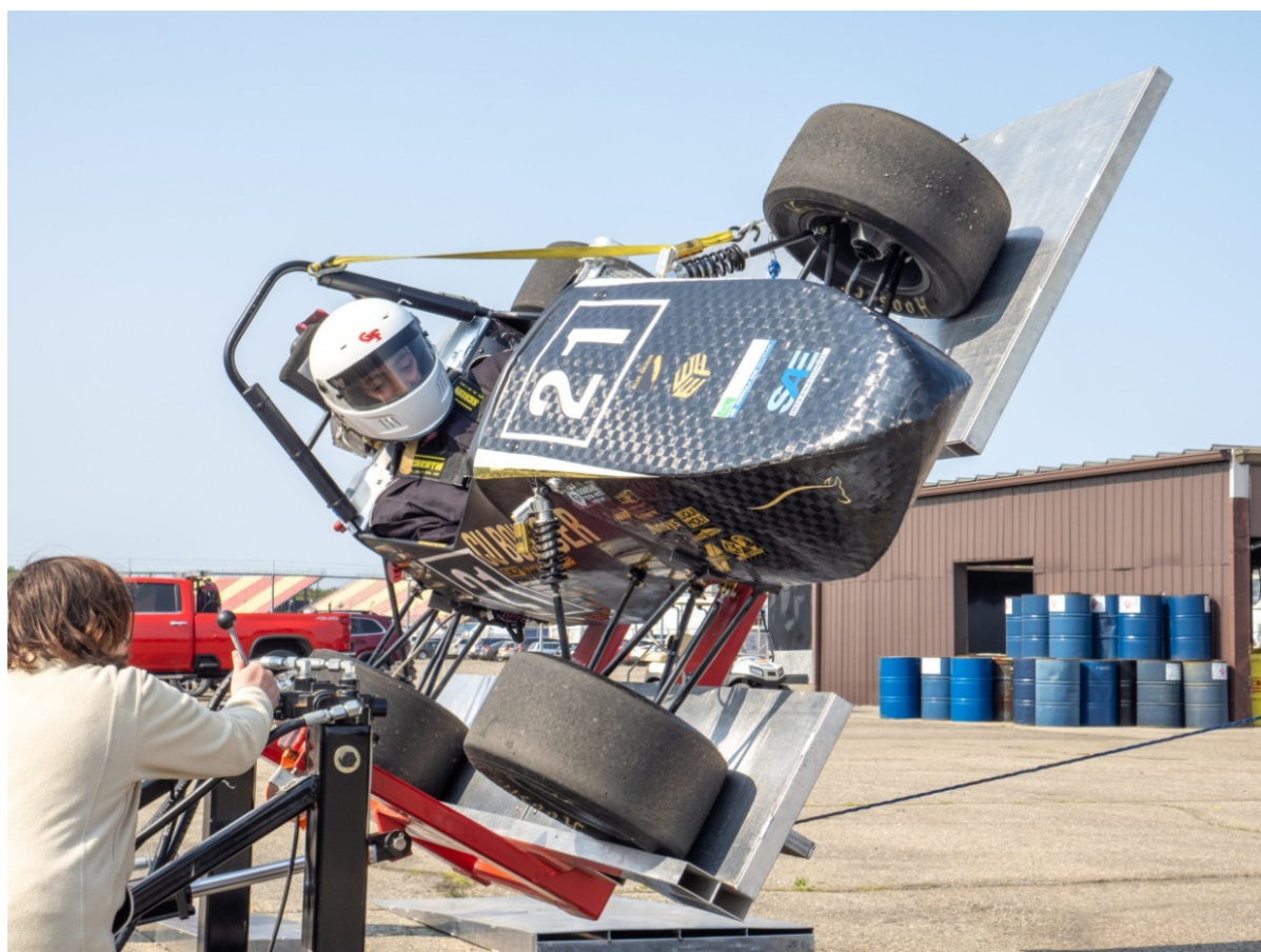
Рисунок 1.2 – Перевірка боліда на герметичність під час нахилу
