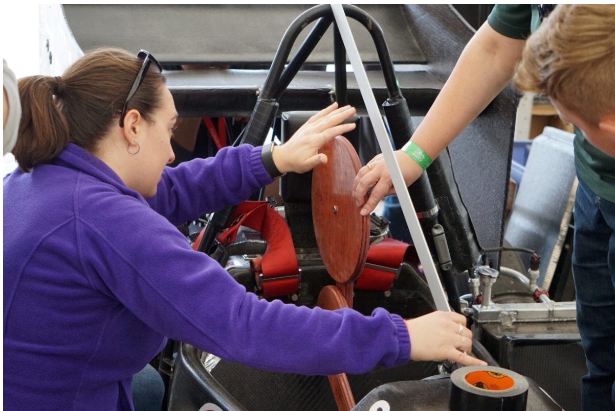
Рисунок 1.3 – Перевірки розмірів кабіни шаблоном людини 95-го процентилля
