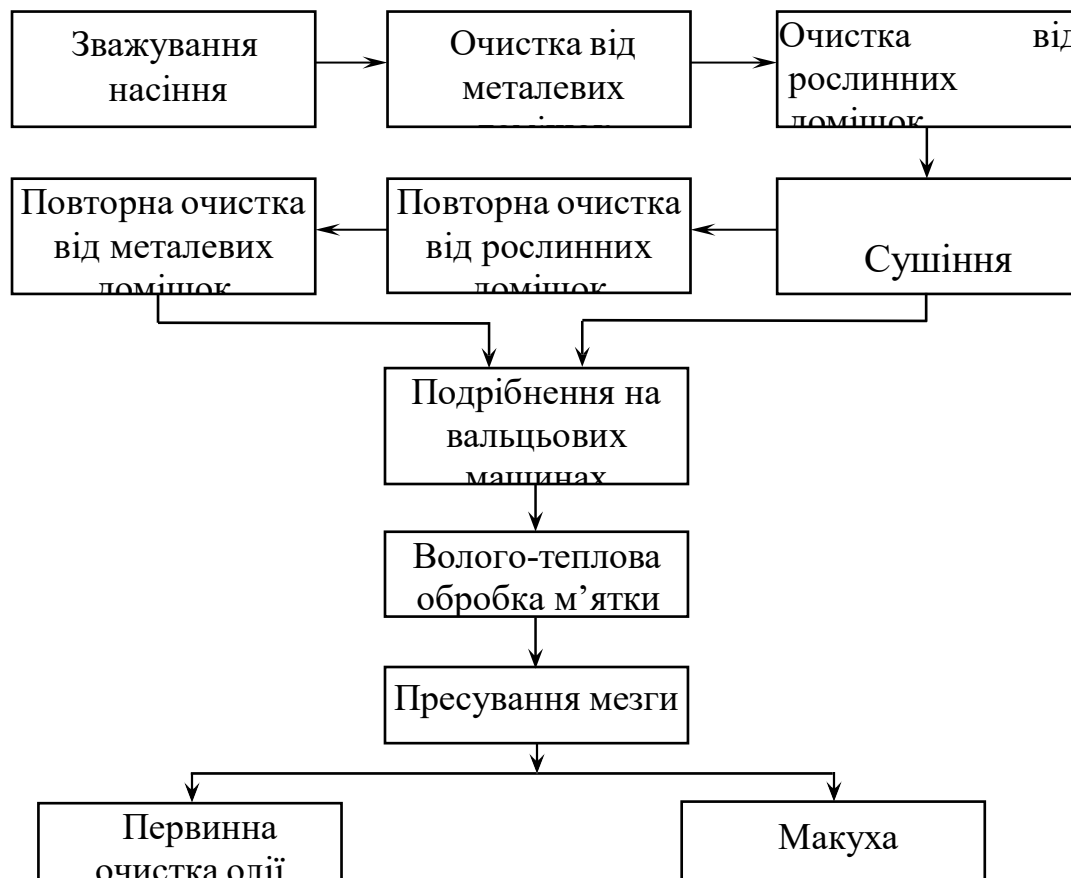
Рисунок 1.1 - Технологічна схема отримання олії одноразовим пресуванням.
