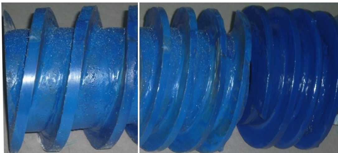
Рисунок 3.4 Двозахідні шнеки із кроком 35 мм, 40 мм і 45 мм.
