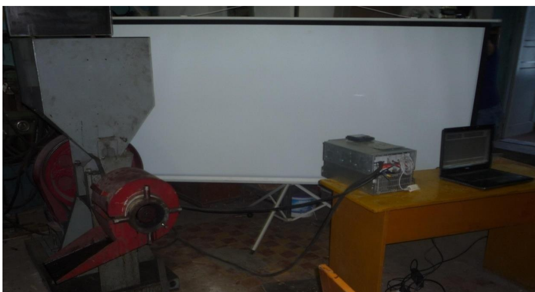
Рисунок 3.3 - Схема контролю параметрів шнекового преса.
