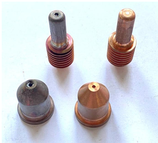
Рисунок 1.2. – Зображення зношених сопла і електрода
