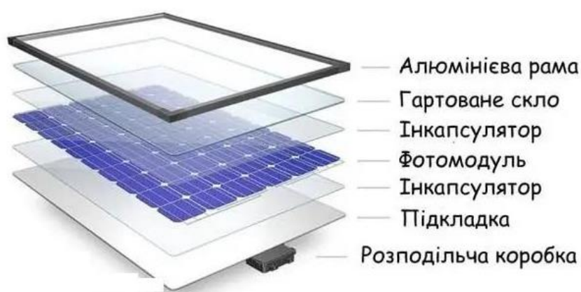
Рисунок 2.2 – Структура сонячної батареї
