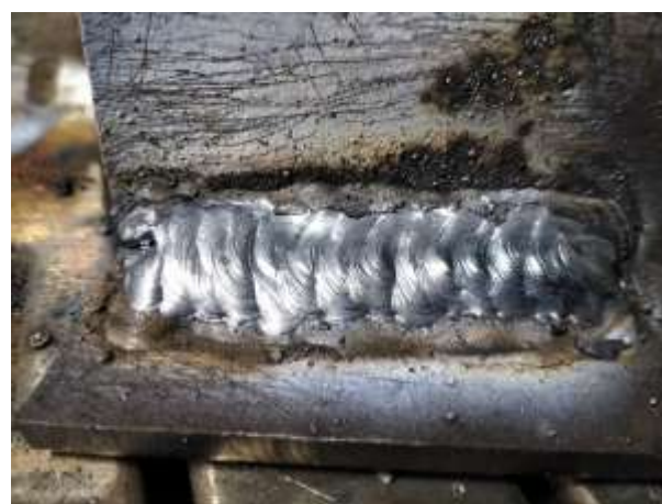
Рисунок 3.6 – Етапи процесу зварювання багатопрохідного зварного шва
