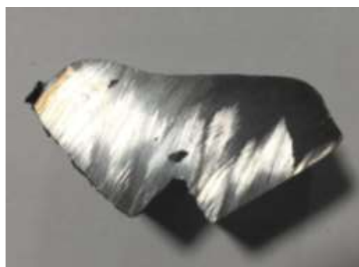
Рисунок 3.9 – Поперечні розрізи зразка багат шарового шва стикового з'єднання товщиною 16 мм і кутом обробки кромки 55°
