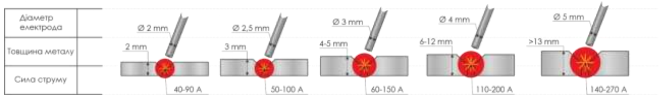
Рисунок 1.10 – Рекомендації до вибору діаметра зварювального електрода
