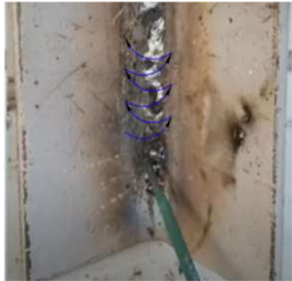
Рисунок 3.11 – Схема руху електрода під час виплавлювання шлакових включень
