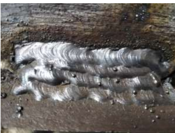
Рисунок 3.6 – Етапи процесу зварювання багатопрохідного зварного шва
