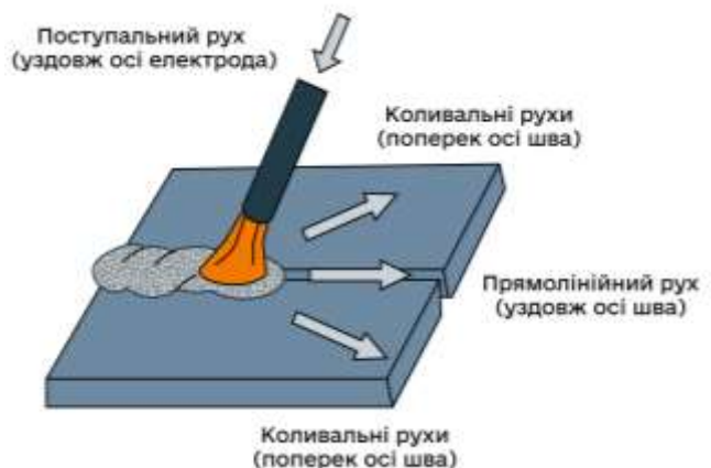
Рисунок 1.7 – Можливі рухи електродом під час зварювання
