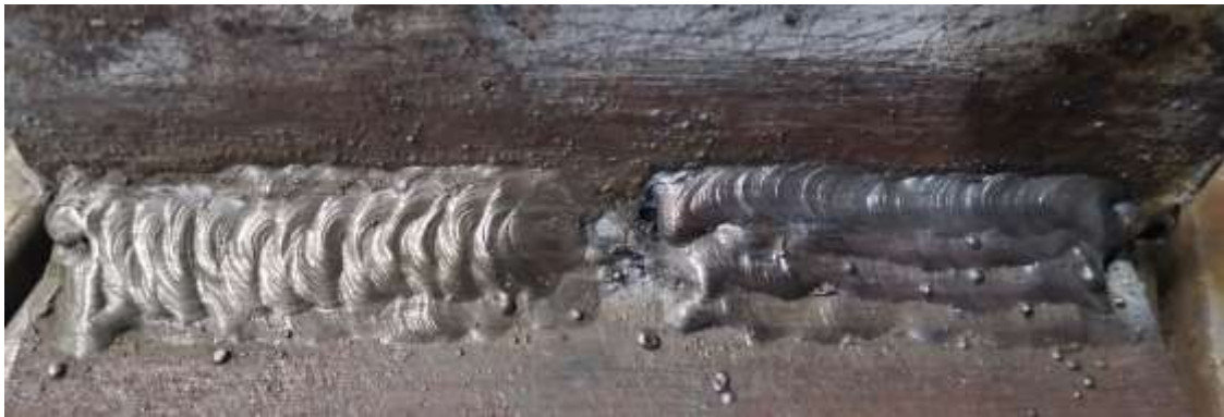
Рисунок 3.7 – Багатпрохідний зварний шов
