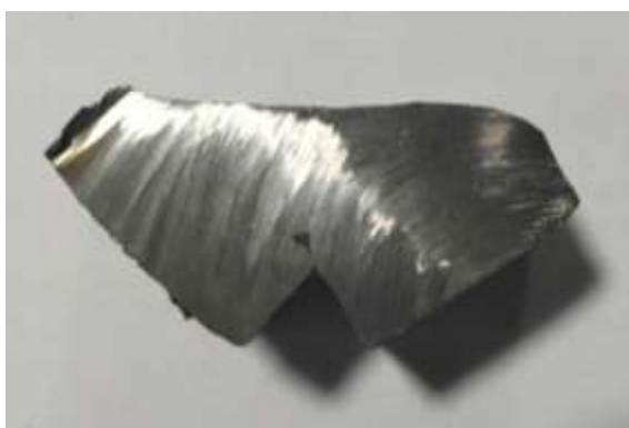
Рисунок 3.9 – Поперечні розрізи зразка багат шарового шва стикового з'єднання товщиною 16 мм і кутом обробки кромки 55°
