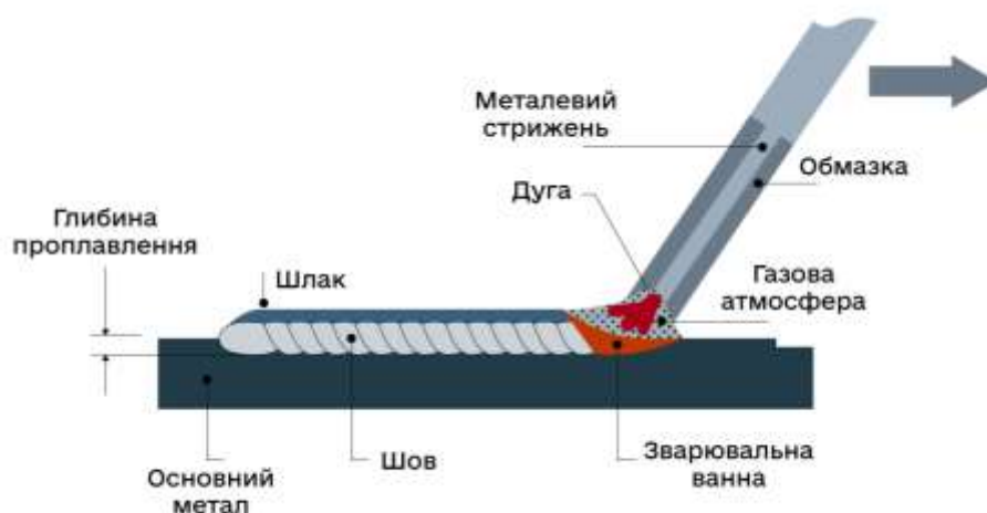
Рисунок 1.2 – схему формування зварного шва
