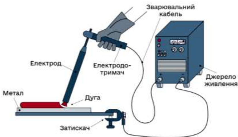
Рисунок 1.1 – Схема процесу ручного дугового зварювання (РДЗ)
