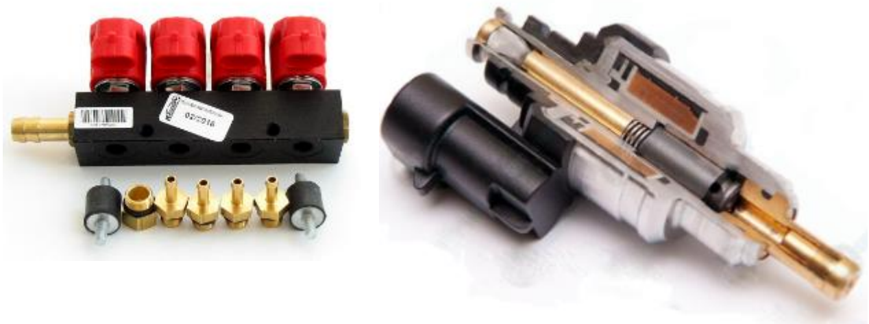
Рисунок 1.5 – Газові форсунки : а) – штокового типу (Valtek Type 30); б) – голчастого типу (Barracuda в розрізі).
