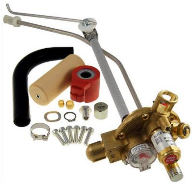
Рисунок 1.3 – Мультиклапан із набором для його монтажу.
