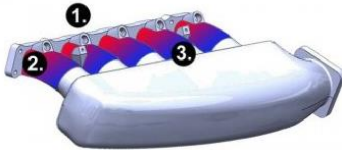
Рисунок 1.7 – Розташування місця врізки газових штуцерів (1 – ідеальне, 2 – допустиме, 3 – неправильне).
