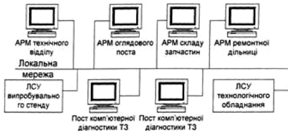
Рисунок 1.4 – Архітектура мережі підсистем виробничих підрозділів АТП
