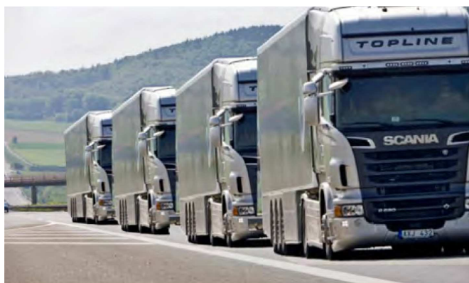
Рисунок 1.2 – Технологія формування колони зрештою дозволить пелотонам перевозити більше двох транспортних засобів (Джерело: Безпека дорожнього руху Великої Британії)
