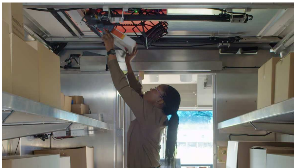
Рисунок 4.3 – Водій завантажує дрон через клітку, підвішену до днища дрона, яка тягнеться до задньої частини вантажівки
