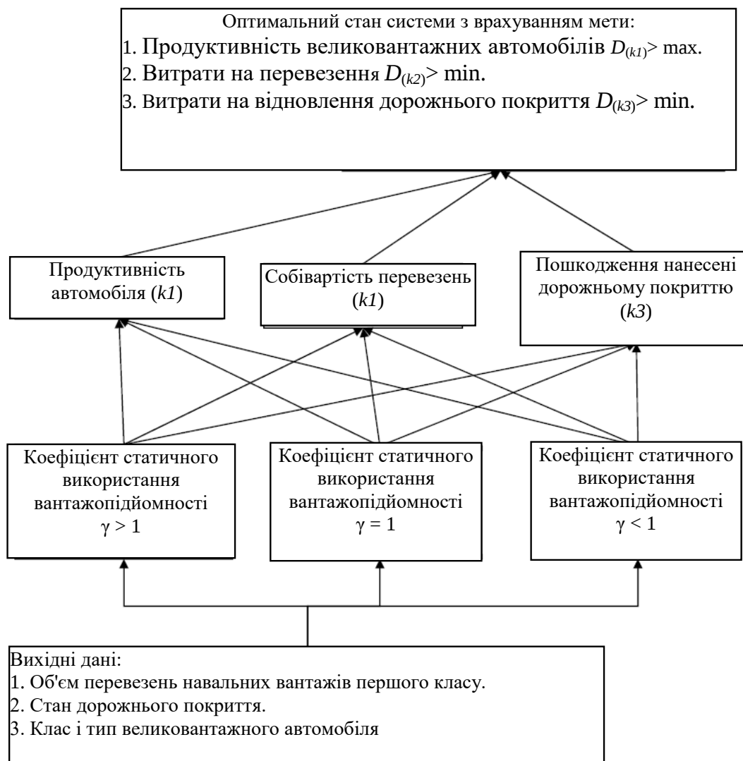
Рисунок 2.5. Композиція моделі систематизованої оцінки показників використання великовантажних автомобілів
