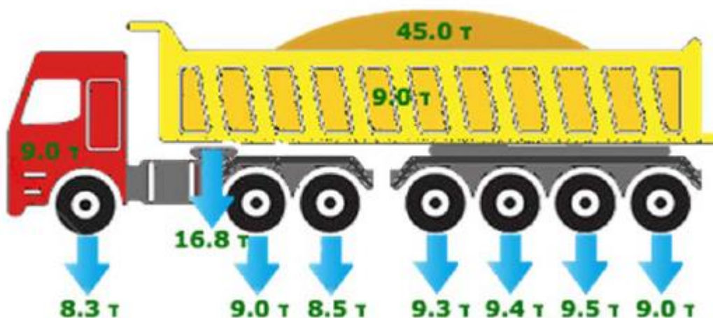
Рисунок 1.4. – Розподіл навантажень на вісь семиосного автопоїзда
