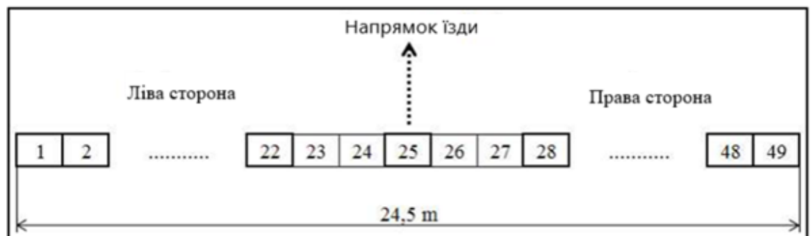
Рисунок 2.1 – Розташування збірних лотків під час вимірювання поперечної рівномірності розкидання відцентровим розкидачем
