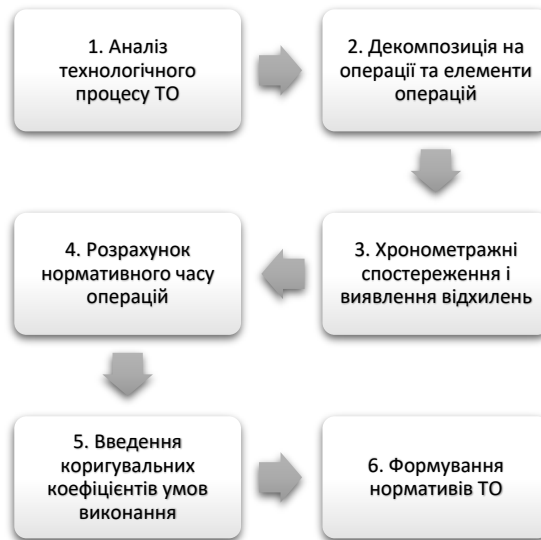
Рисунок 3.2 – Структурно-логічна схема нормування операцій ТО
