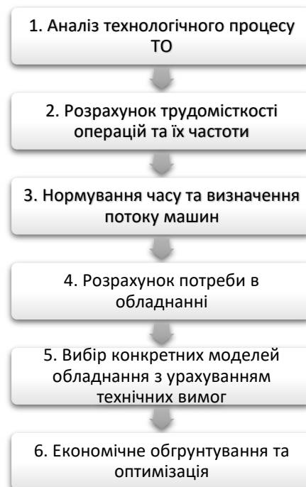
Рисунок 3.1 – Структурно-логічна схема вибору ремонтно-технологічного обладнання
