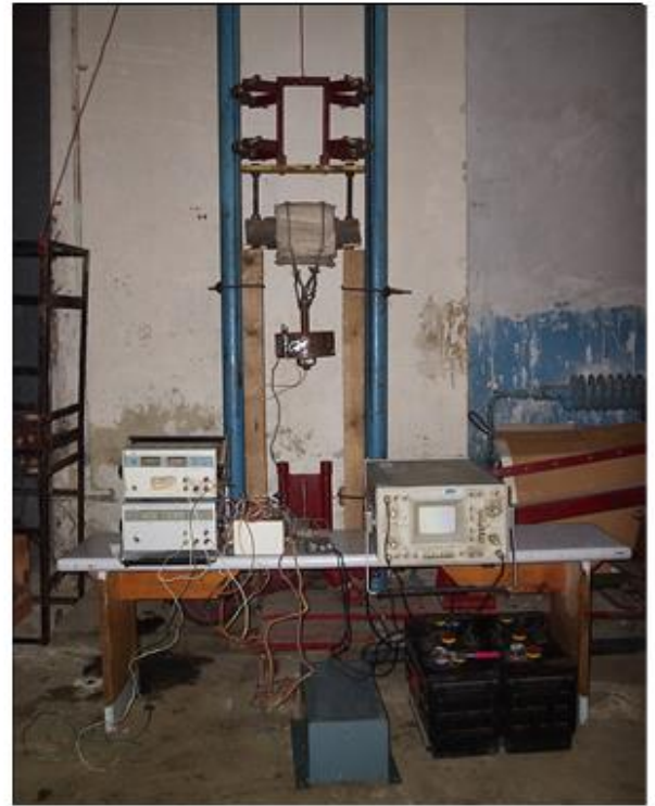
Рисунок 3.1 – Установка для визначення коефіцієнта демпфірування петлі-захвата:
