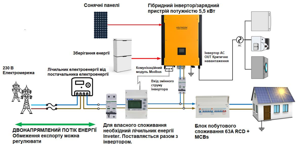
Рисунок 3.1 – Схема гібридної фотоелектричної установки, адаптована до умов особистого селянського господарства
