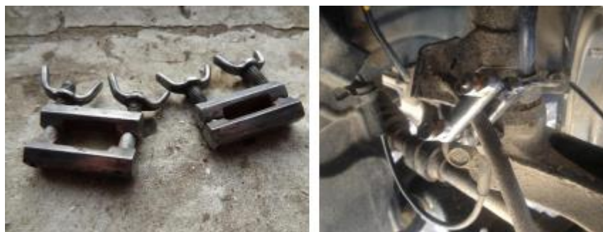
Рисунок 3.3. Затискачі для перекривання гальмівних шлангів (а) і їх встановлення (б)
