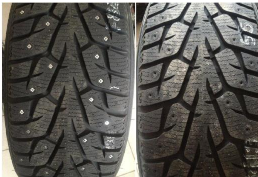
Рисунок 3.2. Зимові шини марки Yokohama IceGUARD Stud iG55: а) з шипами; б) без щипів
