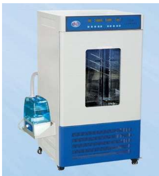
Рис. 1. Загальний вигляд кліматичної камери серії RGX
