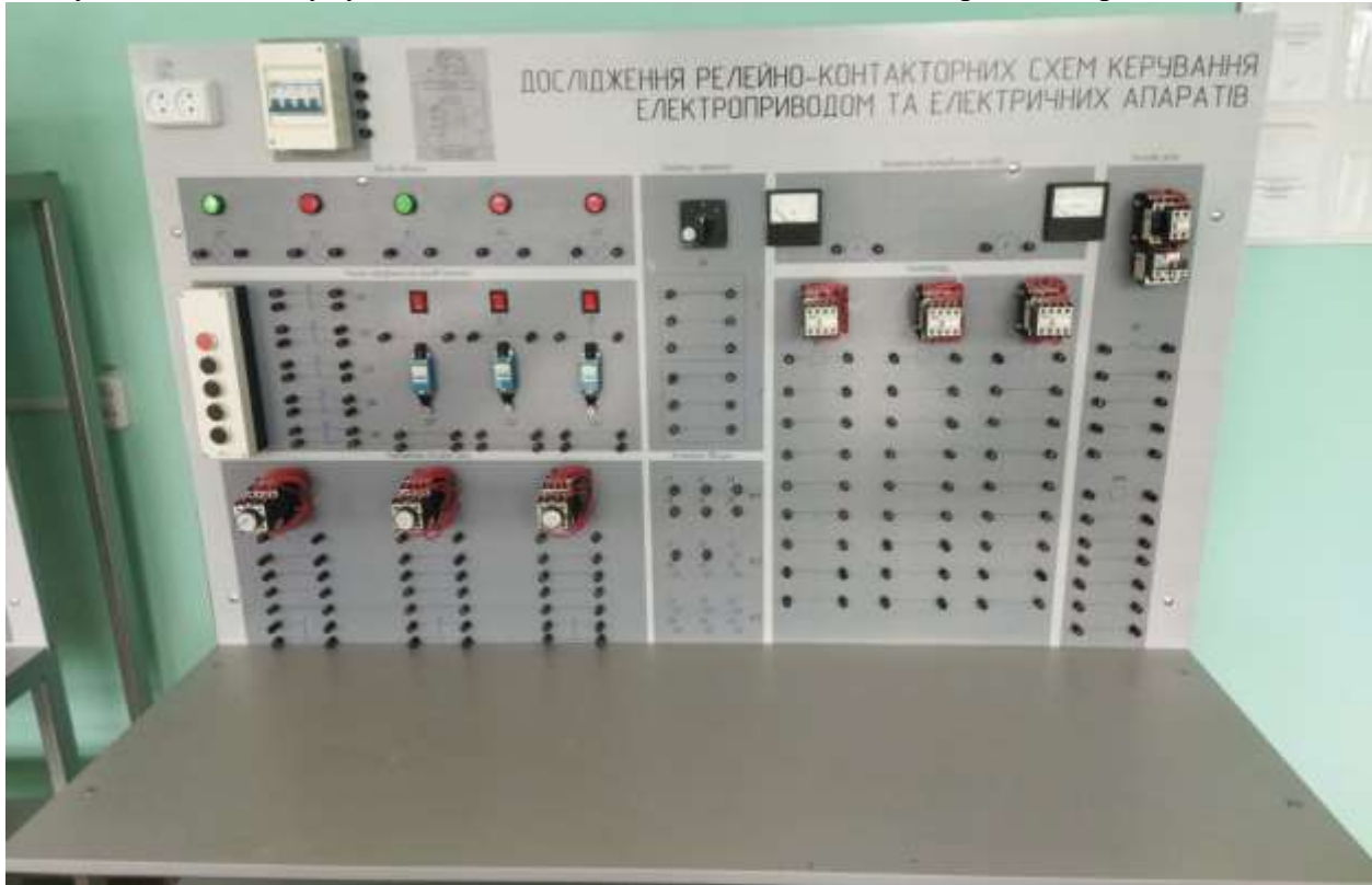
Рис. Стенд, розроблений і виготовлений для вивчення дисципліни «Електропривод виробничих машин і механізмів»
