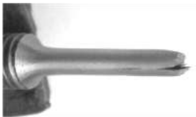
Рис. 2. Розшарування у зразку після випробувань на розтяг
