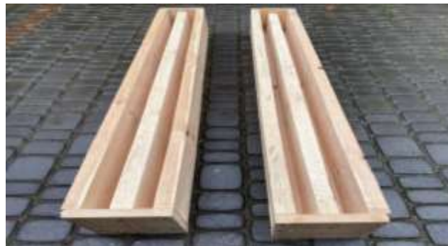
Рис. 2. Форми для виготовлення дослідних зразків
