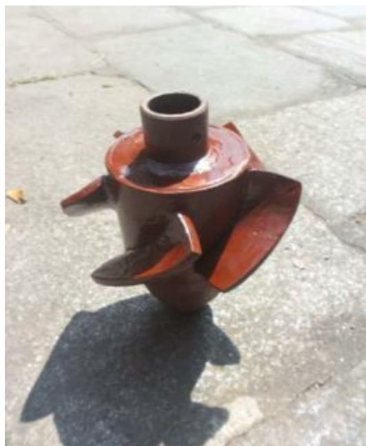
Рисунок 2.15 – Виготовлене робоче колесо пропелерного типу
