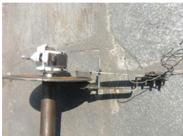
Рисунок 2.14 – Гальмівна система робочого колеса гідротурбіни Каплана
