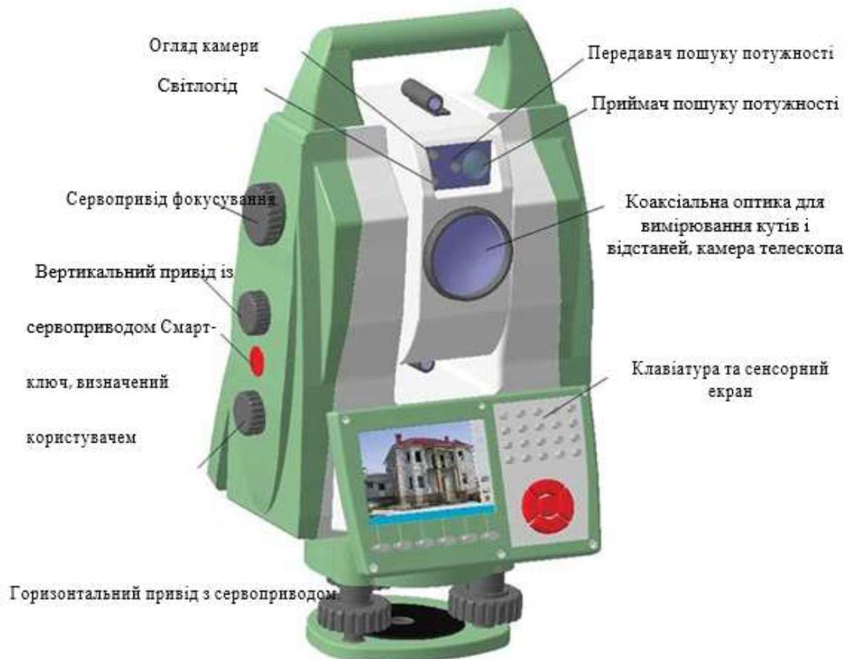
Рис. 3.4. Електронний тахеометр Leica TPS 1205+
