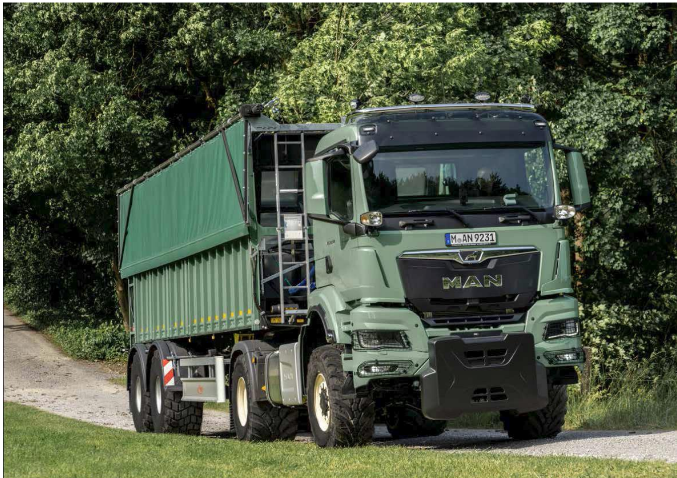
Рис. 3.3. Приклад аграрного автопоїзда MAN з повним приводом тягача і одинарними широко профільними шинами [3].
