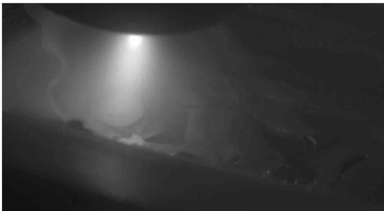
Рисунок 3.10 Класс CONTAMINATION DEF02 (забруднення)
