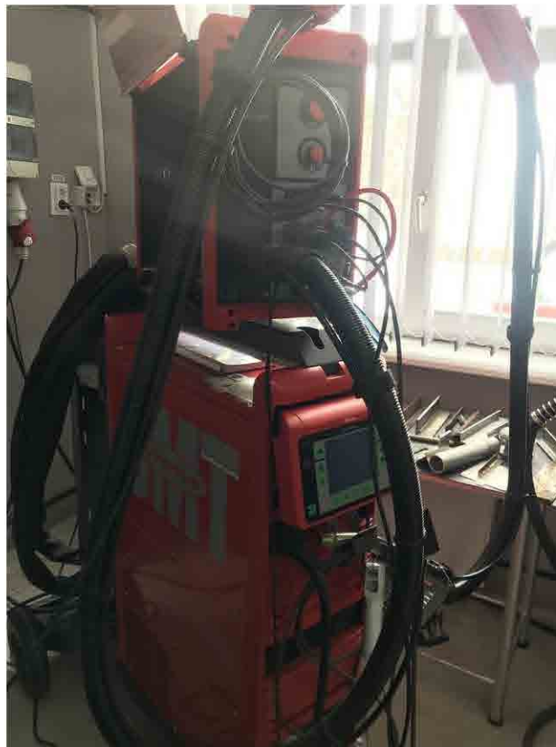
Рисунок 2.2 – Встановлення методу холодного нанесення металевих покриттів.
