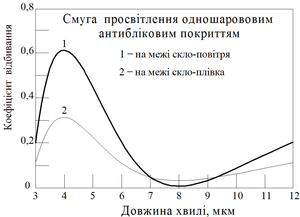
Рисунок 1.9 – Селективне просвітлення спектру відбивання в області максимальної чутливості сонячних елементів [9]
