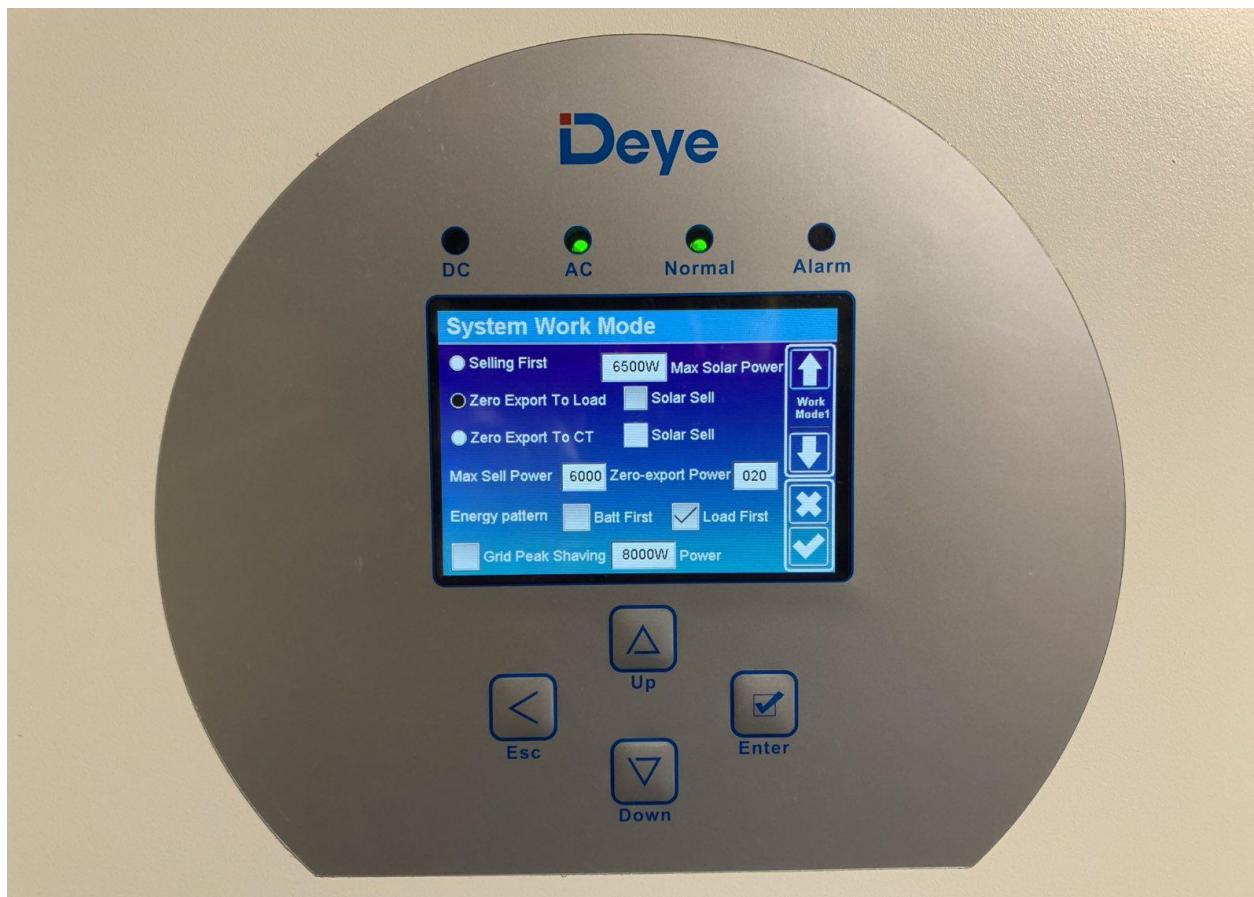
Рисунок 3.4 - Налаштування в меню інвертора нульового експорту по лінії Load "Zero Export To Load"
