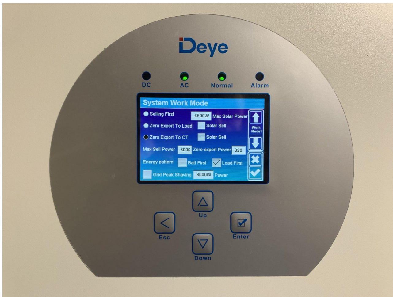
Рисунок 3.5 – Налаштування в меню інвертора нульового експорту до зовнішньої електромережі по лінії Grid "Zero Export To CT"
