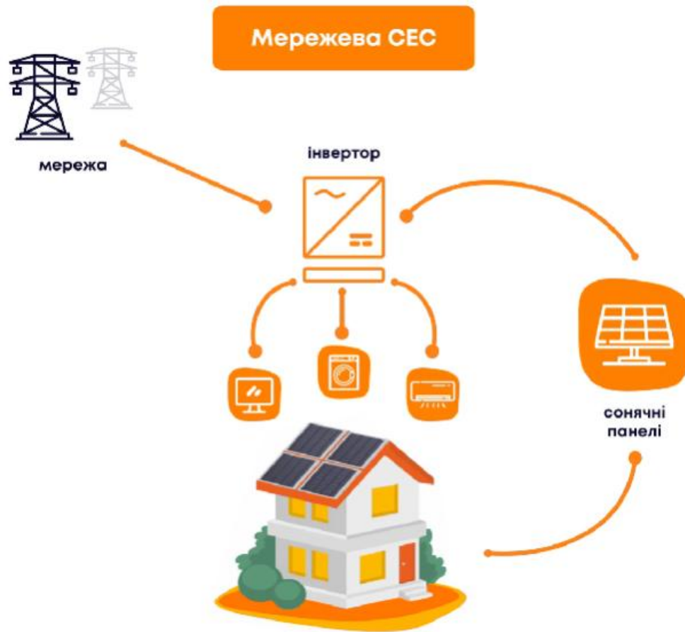
Рисунок 1.7 – Структура мережевої сонячної електростанції [24]
