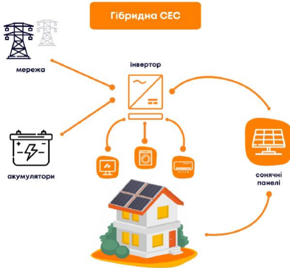
Рисунок 1.9 – Структура гібридної мережевої сонячної електростанції [24]
