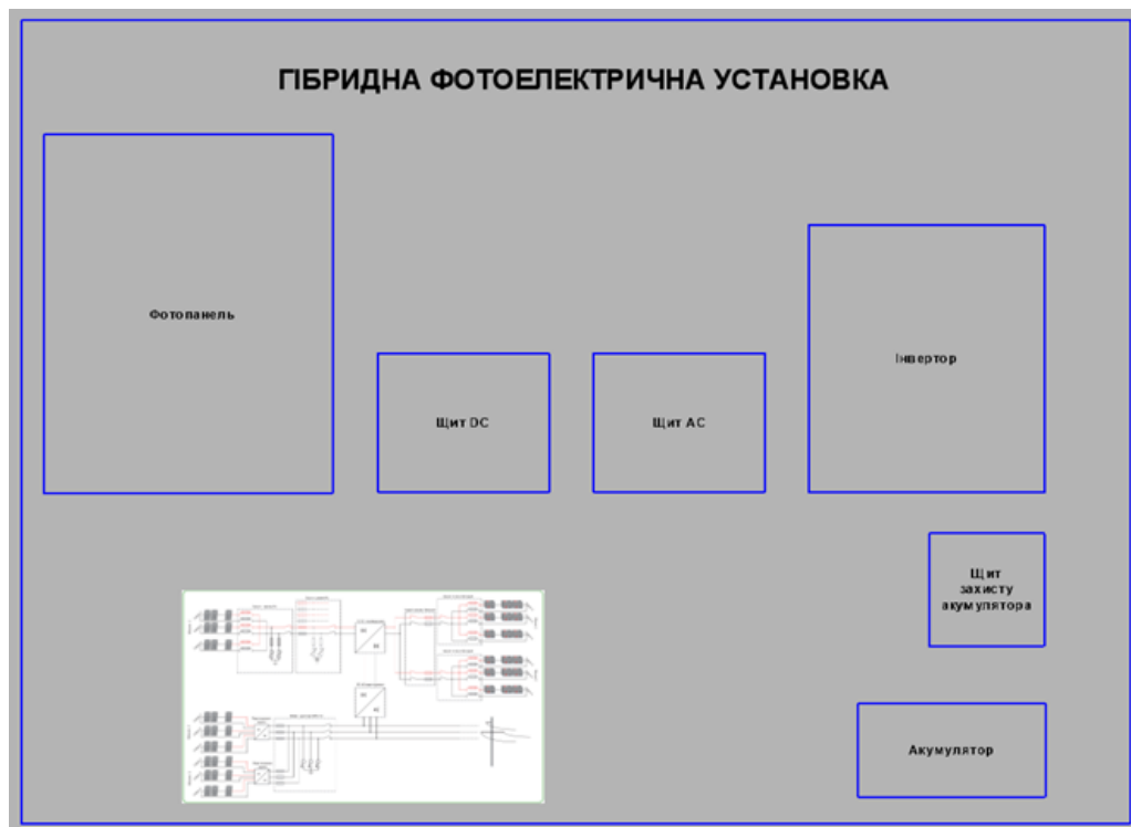
Рисунок 3.6 – Макет лабораторного стенда гібридної фотоелектричної установки
