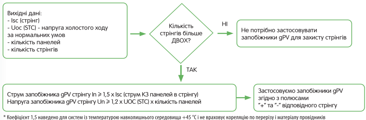
Рисунок 3.8 – Алгоритм вибору запобіжників СН gPV
