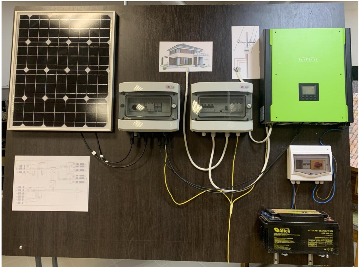
Рисунок 3.7 – Загальний вигляд лабораторного стенда гібридної фотоелектричної установки
