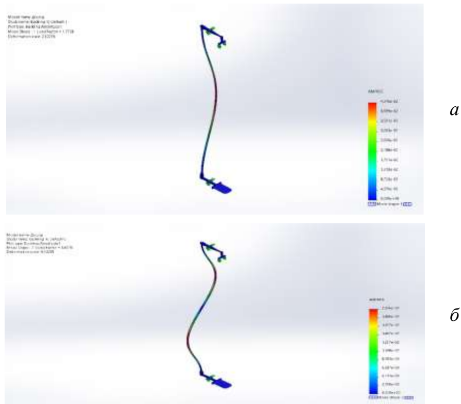
Рисунок 2.24 – Аналіз втрати стійкості: a – перша форма, б – друга форма
