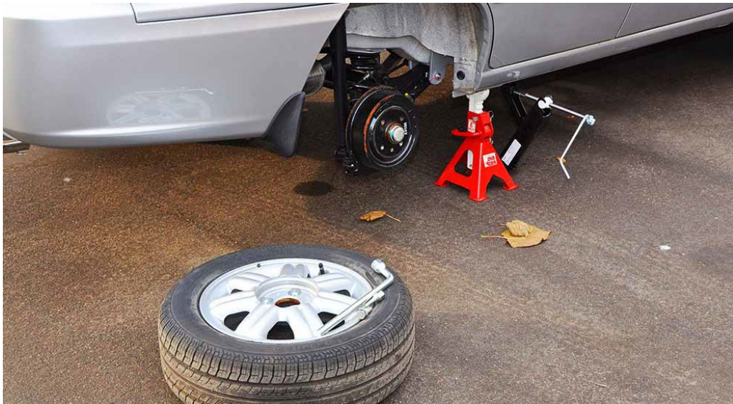
Рисунок 3.3. – Автомобіль піднятий з допомогою домкрата та встановлений на підставку.
