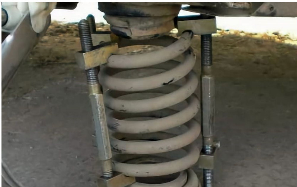
Рисунок 3.4. – Пружина стиснута з допомогою спеціального пристрою.
