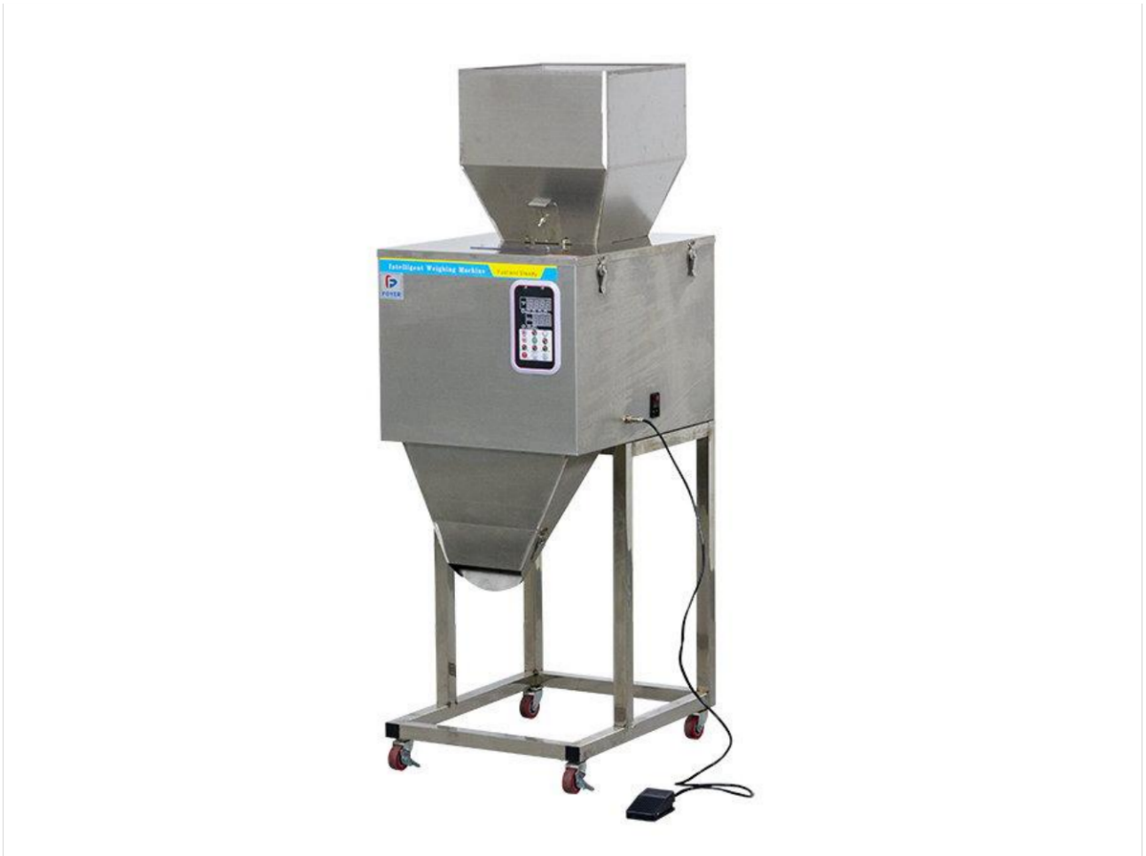
Рис. 1.2. Дозатор ваговий FOYER FZ-5000 вібралотковий прямої дії
