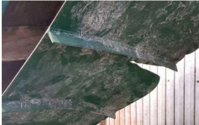
Рис. 1.13. Надірвана конвеєрна стрічка
