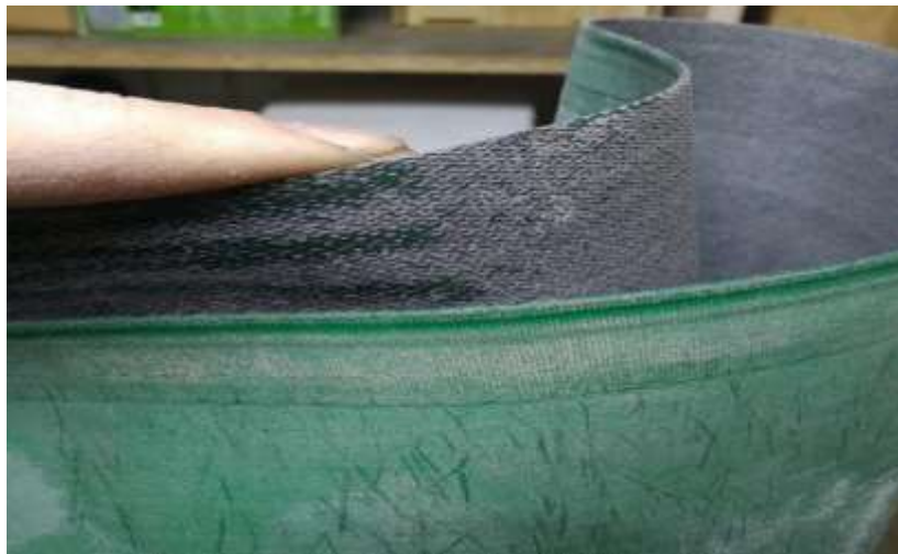
Рис. 1.16. Бічний знос стрічки
