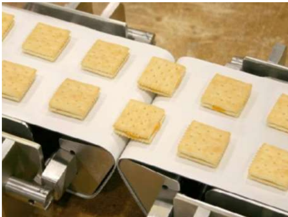
Рис. 1.8. Використання харчової транспортувальної стрічки Ultrasync
