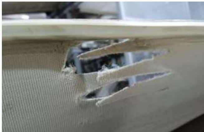
Рис. 1.15. Розшарування стрічки у місцях склеювання
