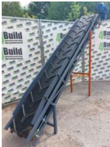
Рис. 1.4. Похилий конвеєр із стрічкою шевронного типу
