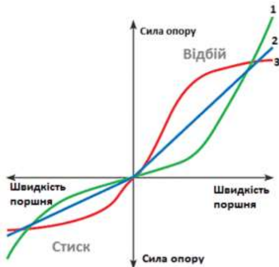
Рис. 1.10. Залежність сили опору P_a та швидкості переміщення поршня v_{\Pi} амортизатора у координатах P_a - v_{\Pi} : 1 - регресивна; 2 - лінійна; 3 - прогресивна.
