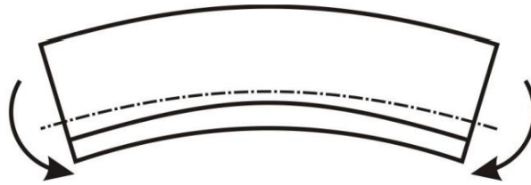
Рисунок 2.3 - Схема деформування балки після зварювання
