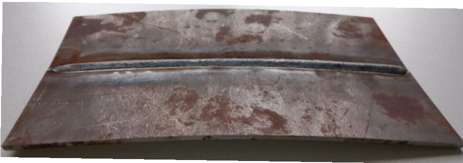
Рисунок 3.16 – Зварні деталі, деформовані після зварювання
