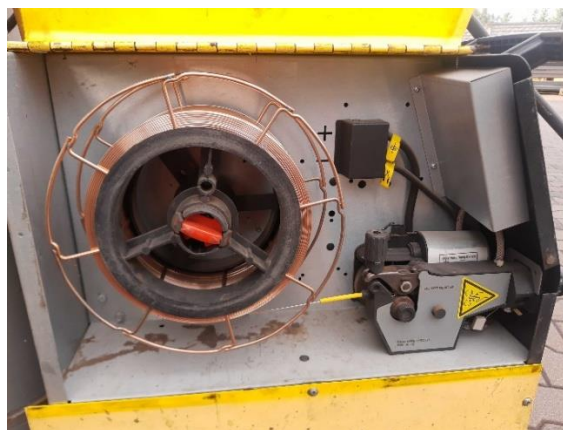
Рисунок 3.4 – Котушка та механізм подачі дроту
