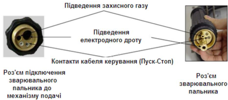
Рисунок 3.9 - Євро-роз'єми для з'єднання пальника з апаратом
