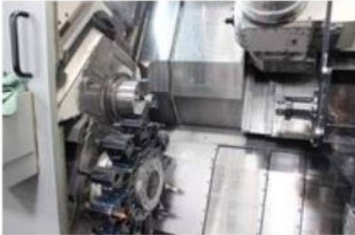
Рисунок 2.3 - Револьверна головка обробного центру
