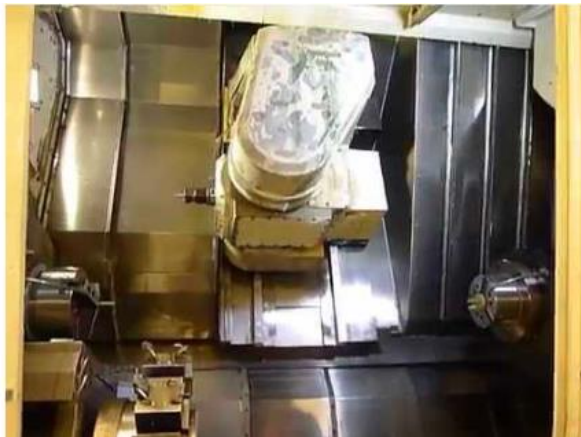
Рисунок 2.2 Фрезерна головка обробного центру
