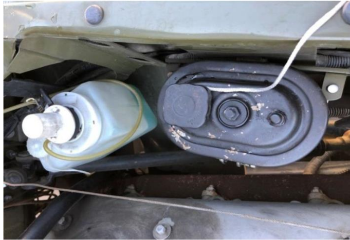
Рисунок 3.5 - Місце вимірювання температури робочої рідини у бачку насосу
