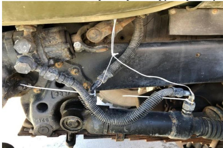
Рисунок 3.4 – Місця під'єднання термопар №2 та №3 до трубопроводів силового циліндра
