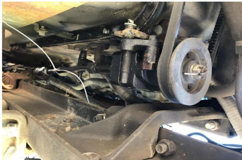
Рисунок 3.3 – Місце підключення термопар до трубопроводу оливного насосу
