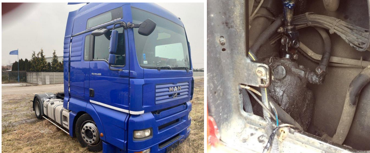
Рисунок 1.7 – Розміщення кермового механізму на автомобілях MAN
