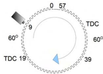
Рисунок 4.6 – Приклад конфігурації запалювання для чотирициліндрового двигуна
