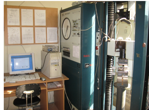
Рис. 4.6 - Загальний вигляд базувального пристрою для триточкового згину балкового зразка з боковою тріщиною. Рис. 4.7 - Загальний вигляд розривної машини «Instron» і запис діаграми руйнування балки при згині
