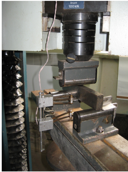
Рис. 4.6 - Загальний вигляд базувального пристрою для триточкового згину балкового зразка з боковою тріщиною. Рис. 4.7 - Загальний вигляд розривної машини «Instron» і запис діаграми руйнування балки при згині
