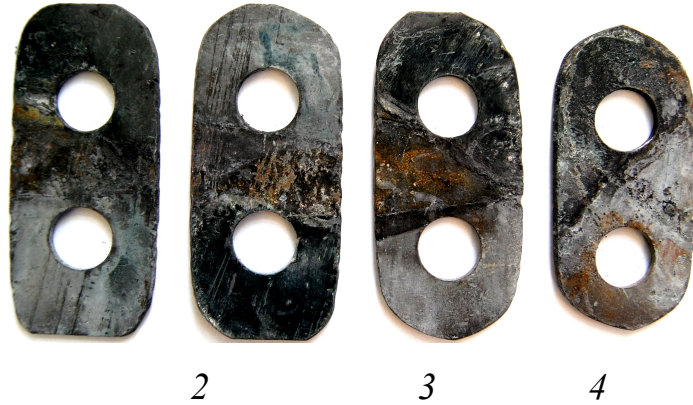
Рисунок 2.1 - Загальний вигляд молотків дробарки ДКУ – після різного ступеня спрацювання: 1 – незначне; 2 – середнє; 3 – середнє двостороннє; 4 – максимальнє двохстороннє
