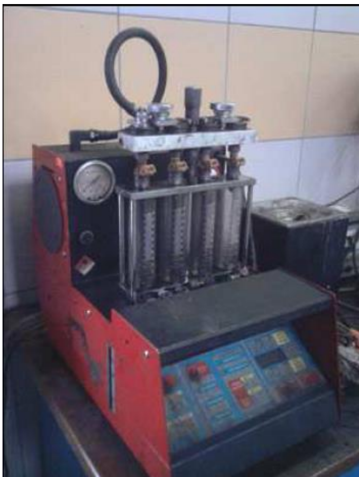
Рисунок 3.5. Визначення динамічної продуктивності електромеханічних форсунок на діагностичному стенді NA4 200W
