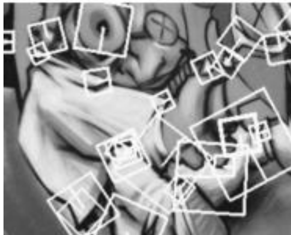
Рис. 1.6. Приклади квадратних вікон (для різних масштабів), що використовуються для обчислення дескрипторів SURF.
